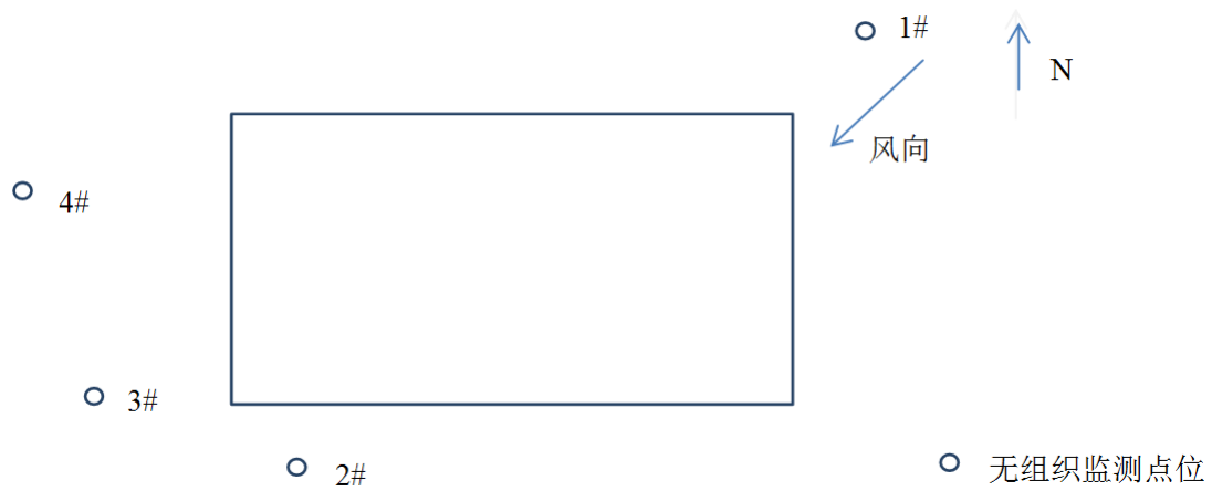
图 7-3 无组织废气监测点位示意图
